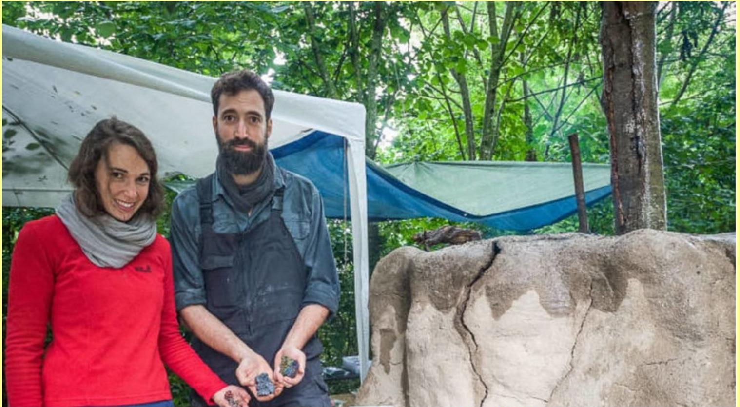
Grâce au four de réduction construit à Melle sur un modèle égyptien, Georges Verly et Charlotte Doyen passent de la malachite au cuivre.
