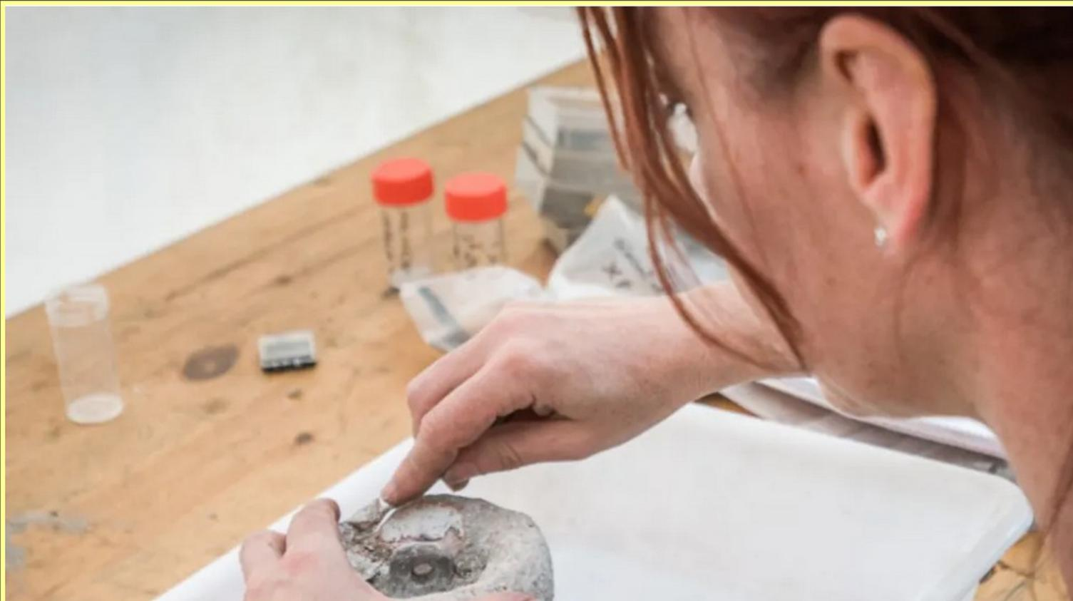
Après refroidissement, le pot contenant l'or et l'argent doit être descellé.
